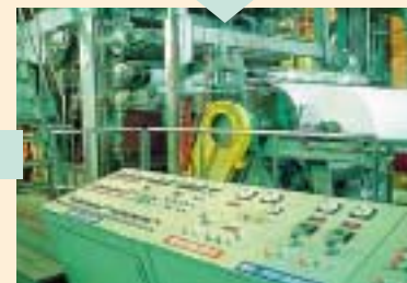
④ロール状に巻き取られる トイレットペーパーの原反 (ジャンボロール)
